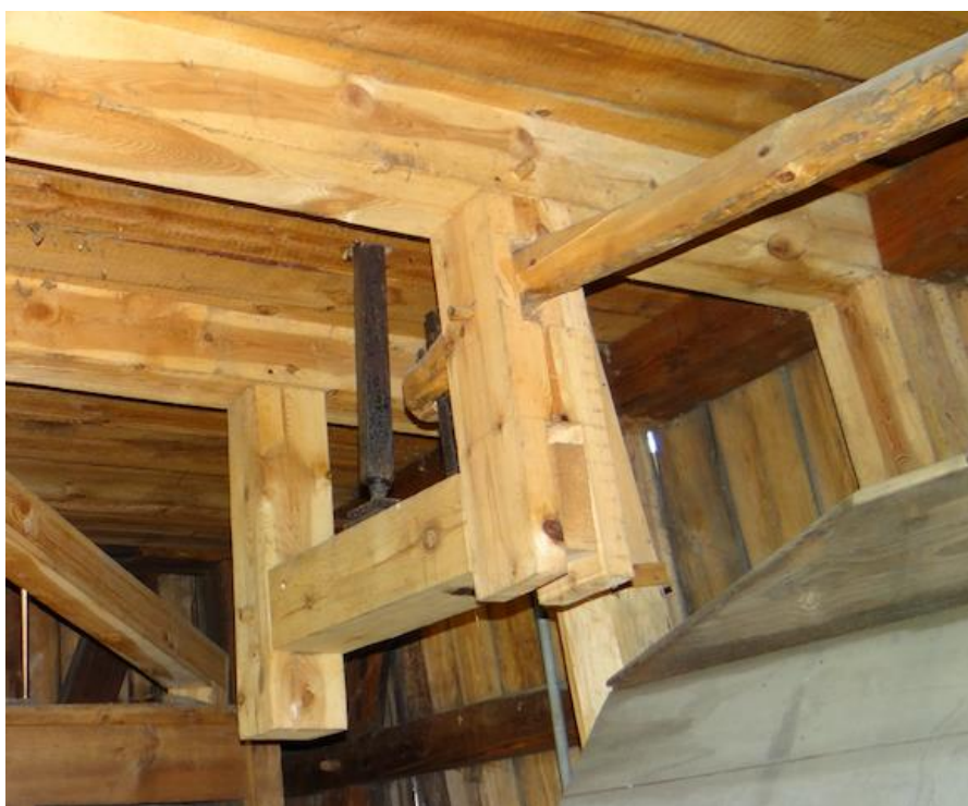
Połączenie współczesne mechanizmu regulacji kamieni przy złożeniu służącym do śrutowania (fot. P. Roszak-Kwiatek)
