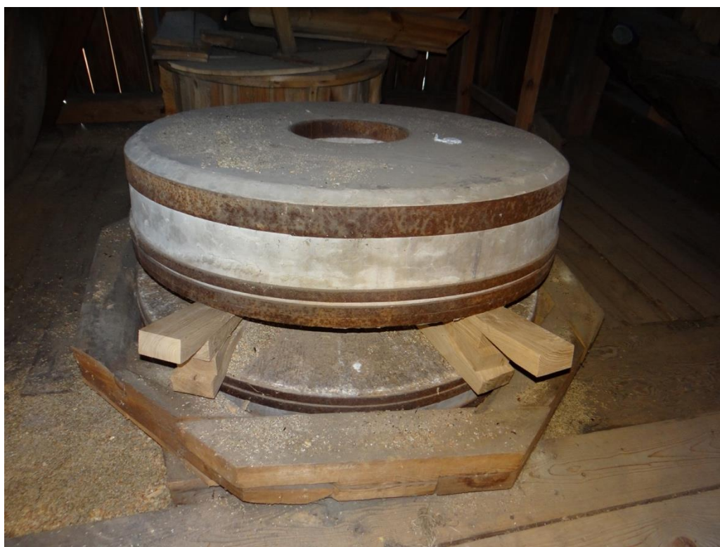
Złożenie kamieni „francuskich” w wiatraku z Zalesia ze zbiorów MWM w Sierpcu (fot. P. Roszak-Kwiatek)
