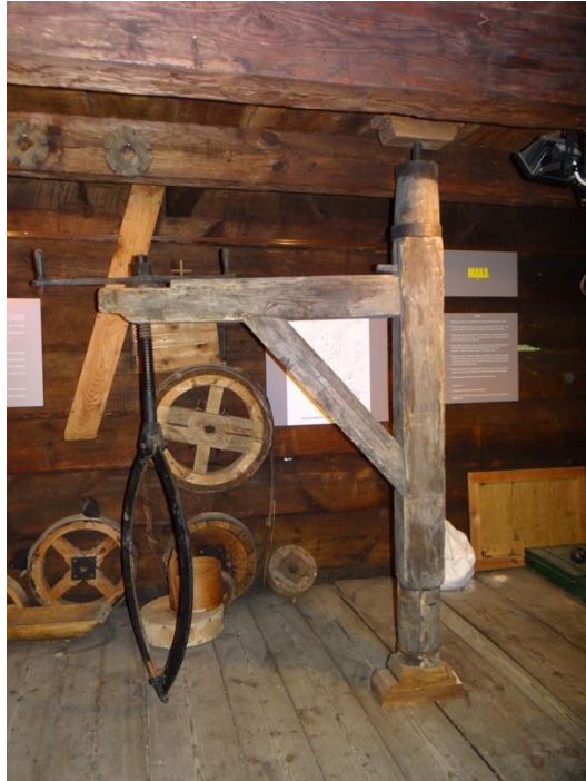
„Żuraw” do demontażu „bieguna” na wystawie młynarskiej w MGPE w Chorzowie (fot. P. Roszak-Kwiatek)
