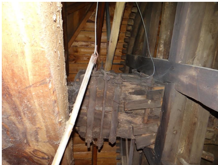
Część wału między dwoma kołami palecznymi znajdującymi się w wiatraku z Zalesia ze zbiorów MGPE w Sierpcu (fot. P. Roszak-Kwiatek)
