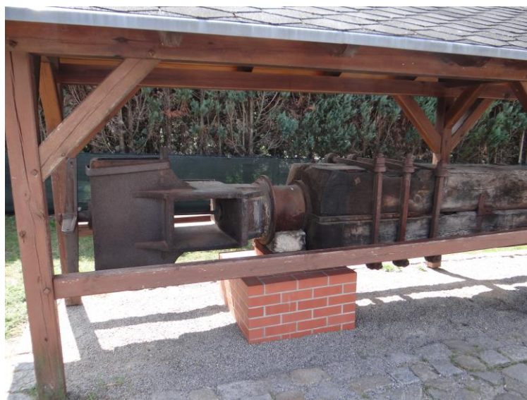
Wał skrzydłowy z Straupitz Mühle (Niemcy). W tym przypadku obejmy spinają cztery „skrzydła” w kształcie (+) złączone z „głowicą”
