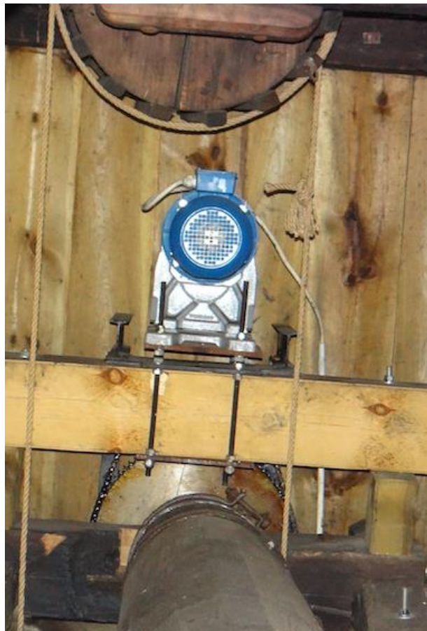
System napędowy w wiatraku z Grzawy ze zbiorów MGPE (fot. P. Roszak-Kwiatek)
