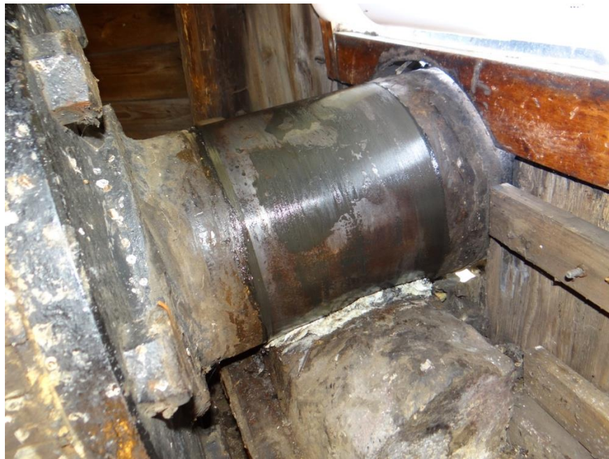
Wał skrzydłowy oparty na kamiennym łożysku smarowany świńskim łojem w Kottmarsdorf Mühle (Niemcy)
