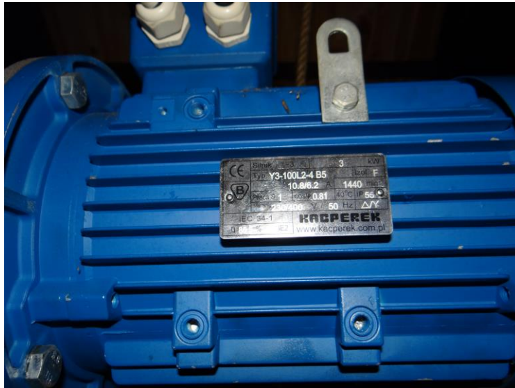
Tabliczka znamionowa silnika zastosowanego w wiatraku z Grzawy ze zbiorów MGPE (fot. P. Roszak-Kwiatek)
