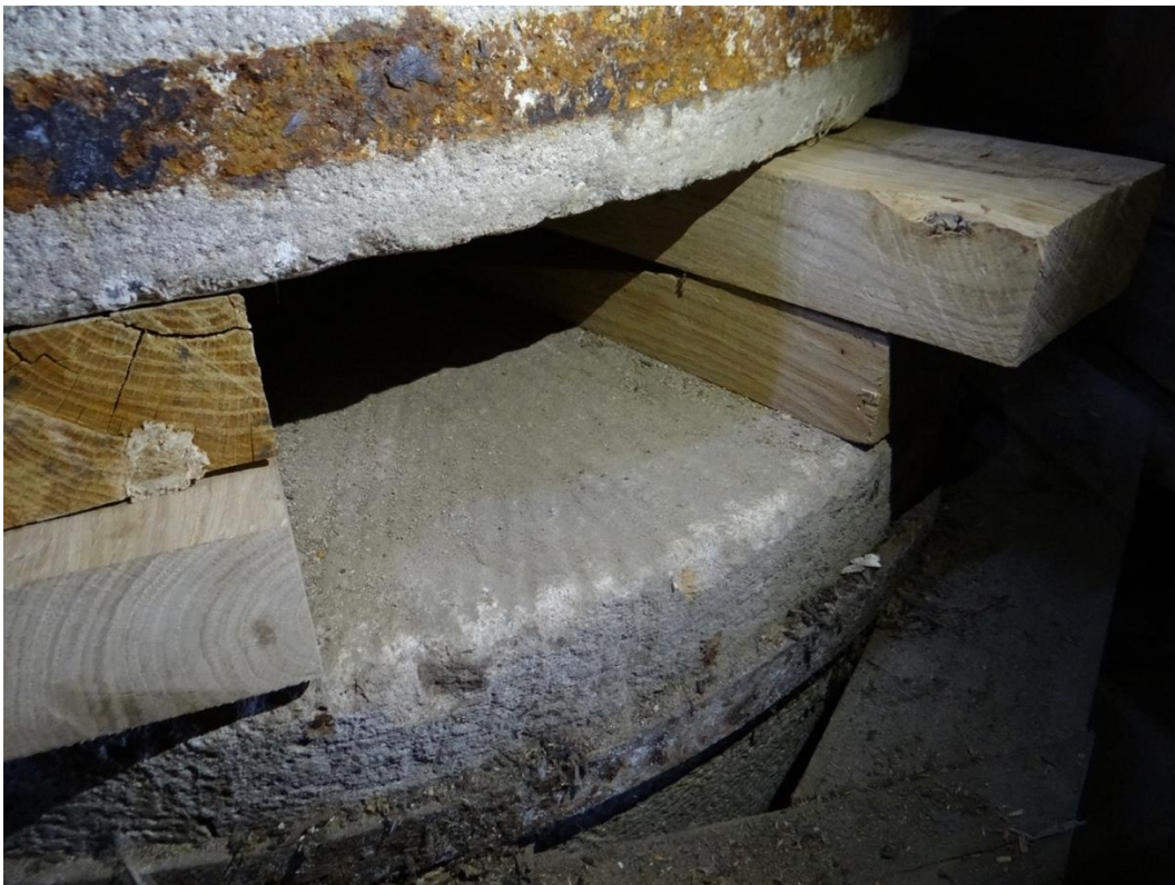
Złożenie kamieni do wyrobu śruty w wiatraku z Zalesia ze zbiorów MWM w Sierpcu (fot. P. Roszak-Kwiatek)
