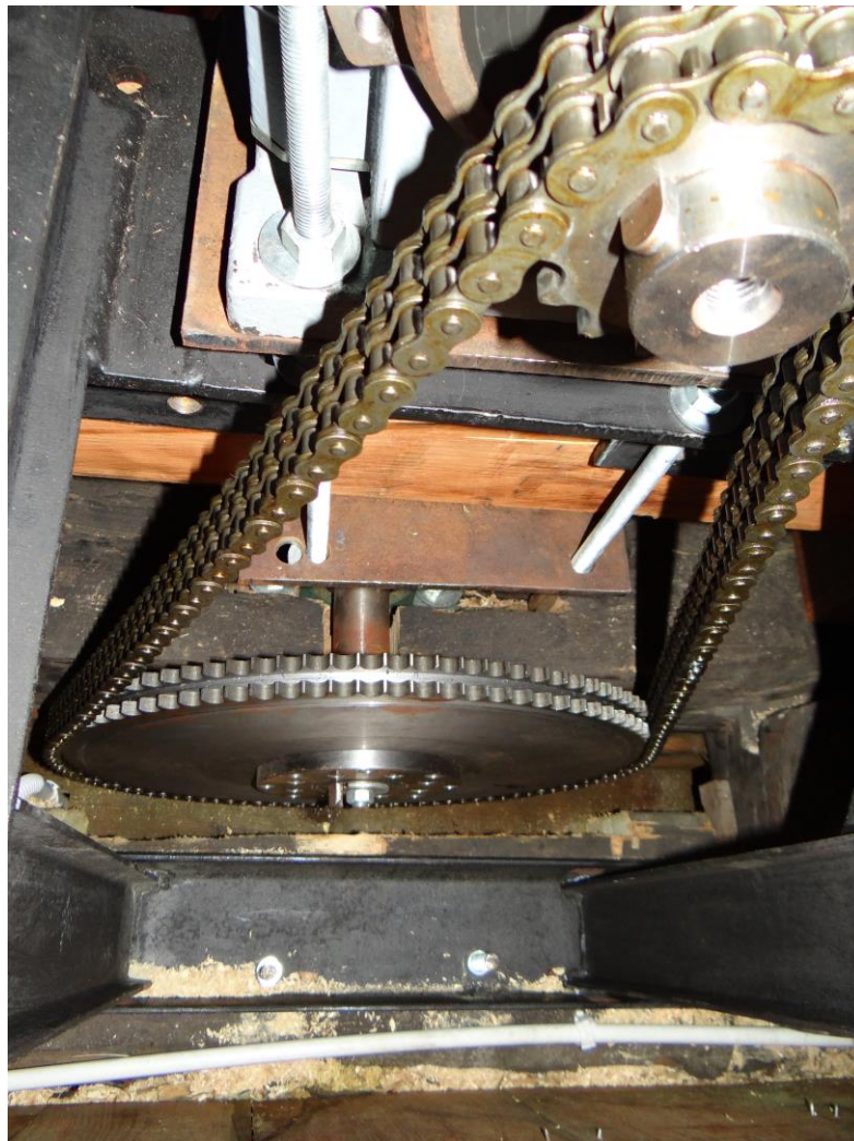
Połączenie wału z silnikiem ze zbiorów MGPE. Na zdjęciu widoczne „małe” koło, podwójny łańcuch oraz koło „duże” (fot. P. Roszak-Kwiatek)
